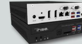
Ermöglicht den Fernzugriff auf mehrere einzelne Computer über ein IP-Netzwerk. Unterstützt mehrere gleichzeitige Sitzung in verschiedenen Multiview-Modi.
